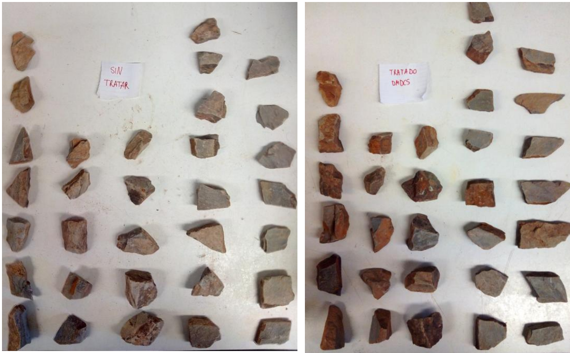
Figura 3-15 : Planta de las partículas similares escogidas para los ensayos de compresión uniaxial. Derecha: partículas naturales e izquierda: partículas hidrófobas. Numeración empezando en el 1, de izquierda a derecha y de abajo hacia arriba.
