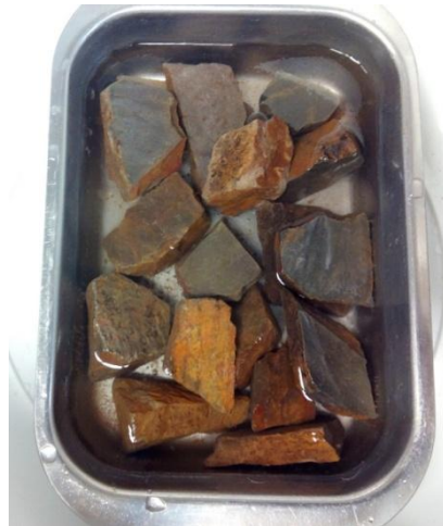
Figura 3-12: Muestra de prueba (410g) sumergida en el DMDCS (1,91 ml) después de reaccionar con el agua desionizada dentro del desecador.
