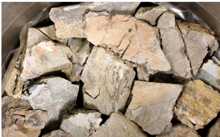
Figura 4-14 : Estado de la muestra justo después de la apertura del edómetro.
