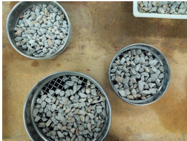
Figura 3-18: Proceso de tamizado de las gravas calizas. Tamices utilizados: UNE 15 mm y UNE 10 mm.
