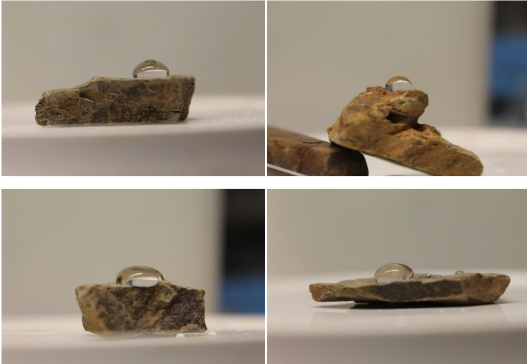
Figura 0-9 : Ejemplos de las fotos tomadas para el cálculo del ángulo de contacto. Muestra M3.
