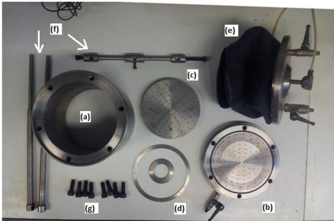
Figura 3-9: Elementos del edómetro. (a) Anillo edométrico, (b) base inferior, (c) cabezal superior, (d) anillos de asiento de la membrana, (e) membrana de látex unida al vástago y a la tapa, (f) marco y (g) tornillos.
