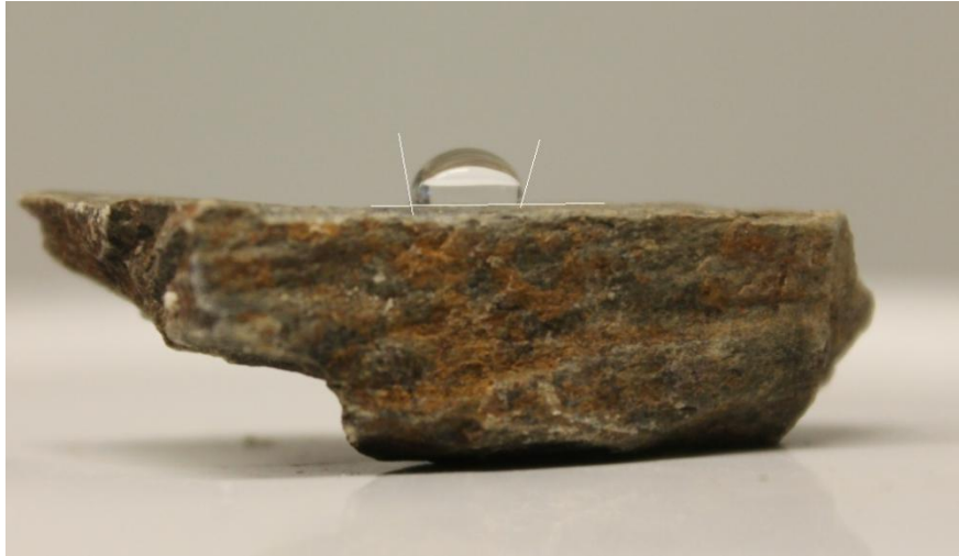
Figura 4-4: Medición de los ángulos de contacto con AutoCAD 2014 a partir de las fotografías tomadas.
