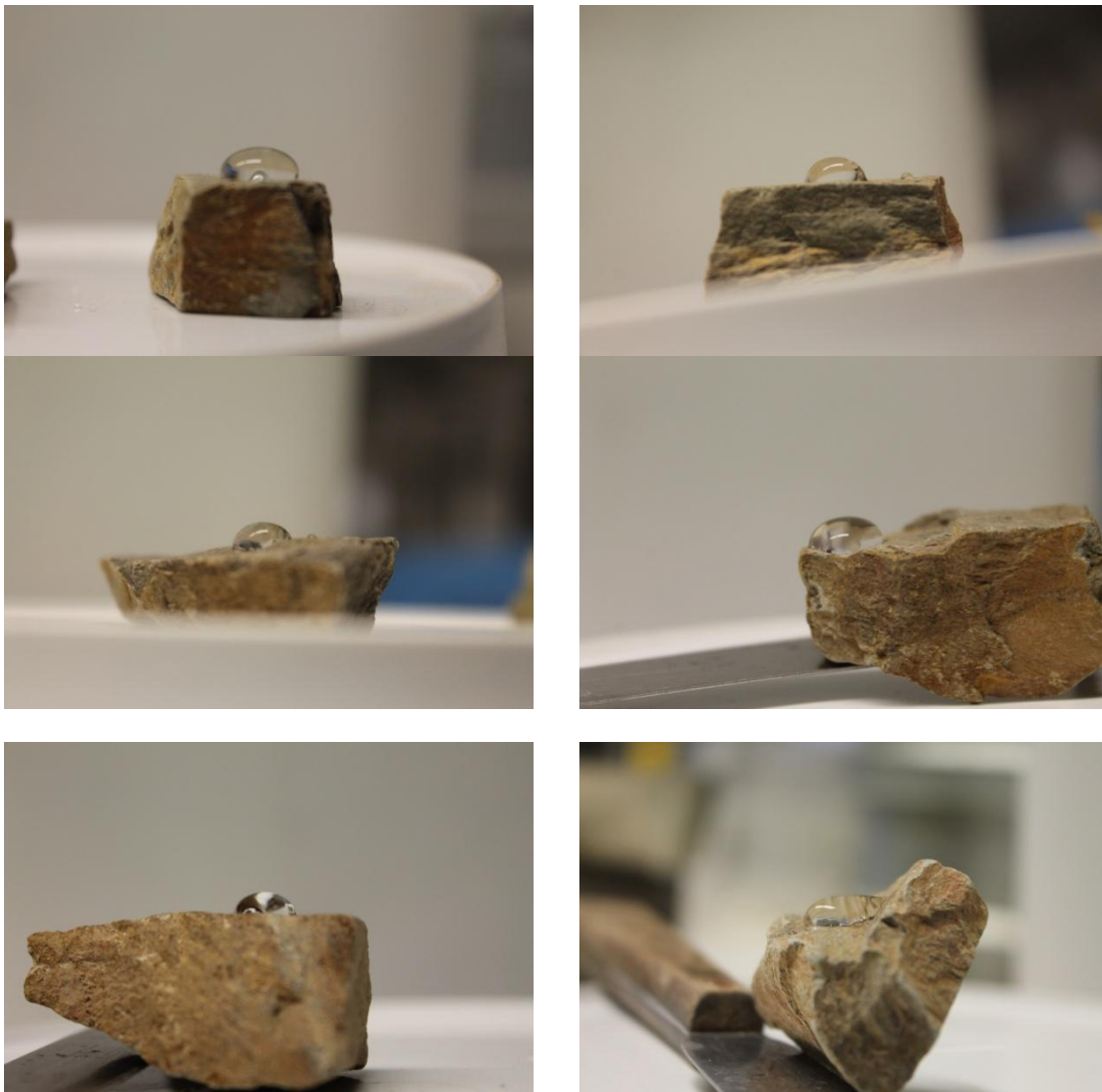
Figura 0-7 : Ejemplos de las fotos tomadas para el cálculo del ángulo de contacto. Muestra M1.
