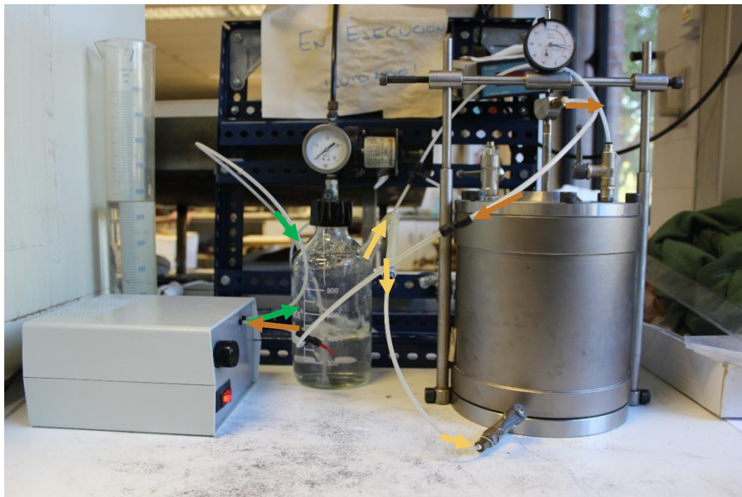
Figura 3-10: Circuito de vapor de agua. En amarillo entrada al edómetro, en marrón salida del edómetro y en verde inyección de aire.
