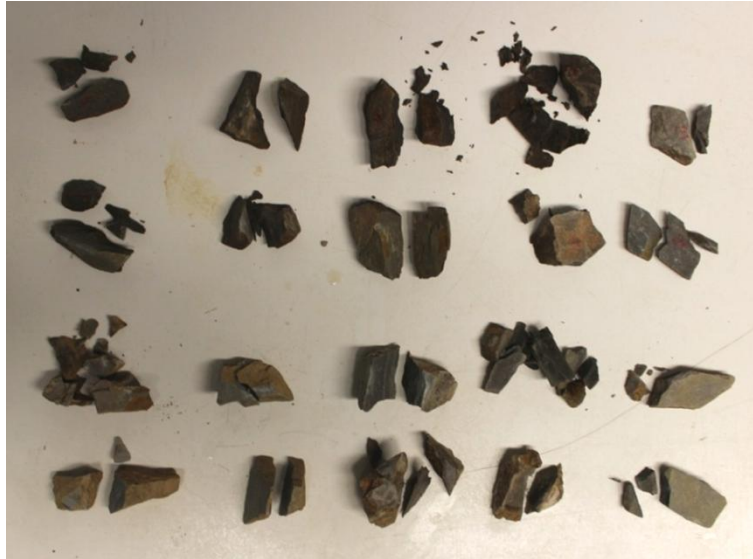
Figura 0-14 : Partículas tratadas y naturales tras el ensayo en condiciones secas.
