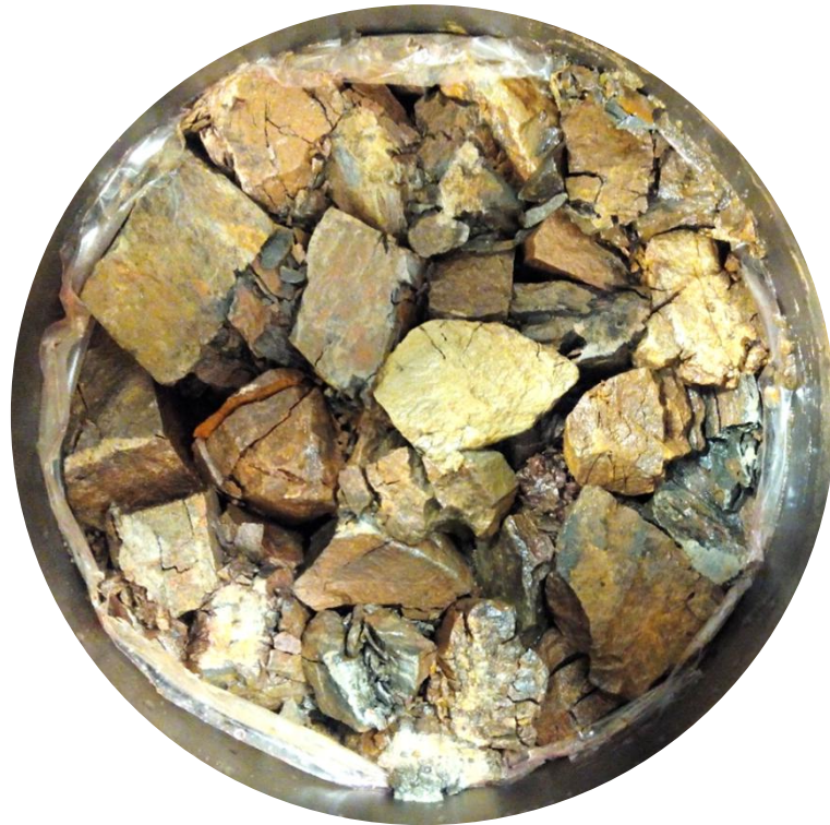
Figura 4-18: Fotografías de las partículas superficiales de la muestra correspondiente al E2P-D30-CID una vez introducidas al edómetro. (a) Antes del ensayo y (b) después del ensayo.
