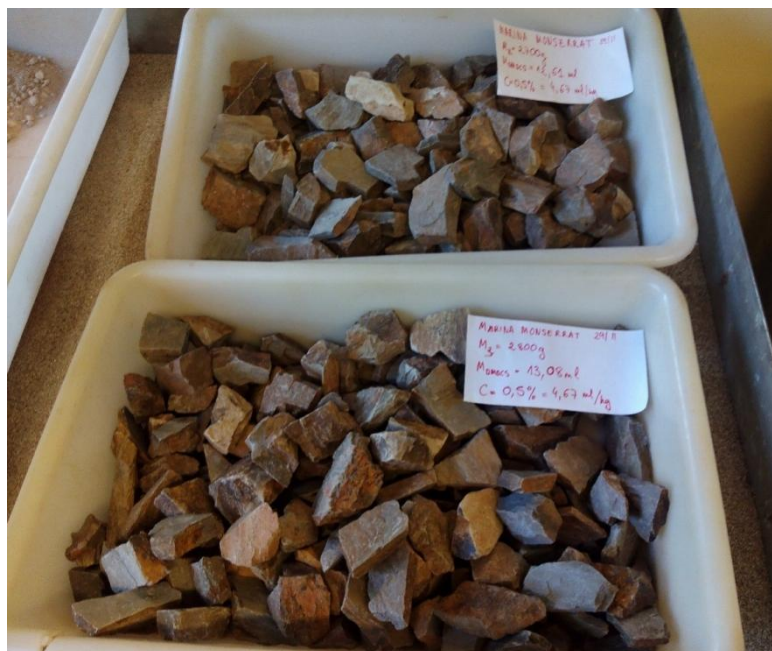
Figura 3-5: Muestras M2 y M3 secándose para ser tratadas con DMDCS.
