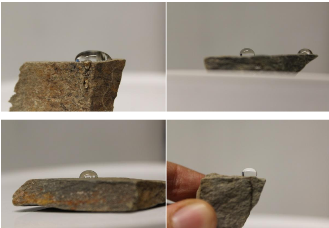
Figura 0-10 : Ejemplos de las fotos tomadas para el cálculo del ángulo de contacto. Muestra M4.
