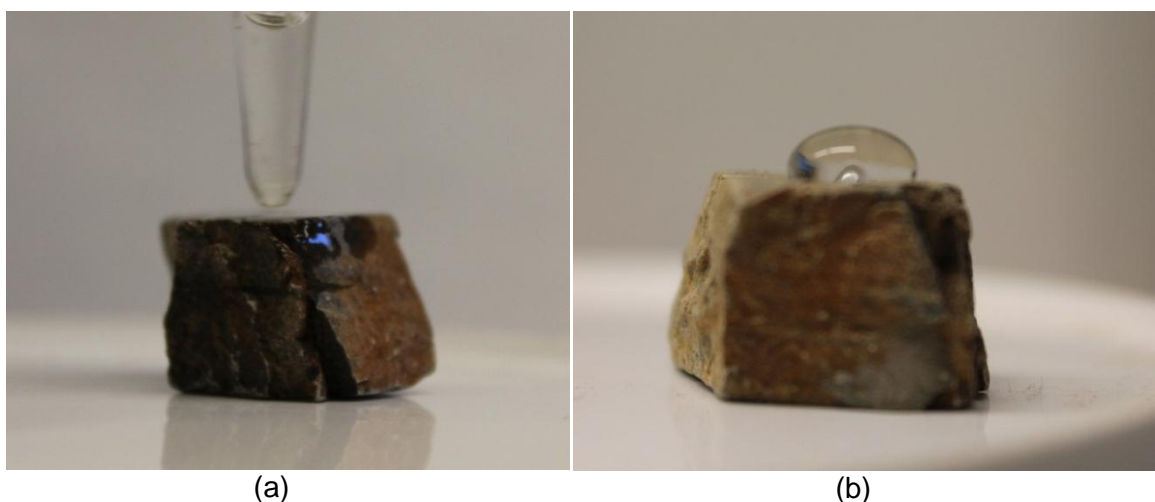
Figura 4-3 : Forma de una gota de agua pipeteada encima de una misma superficie de pizarra (a) antes de ser tratada y (b) tras el recubrimiento hidrófobo a base de DMDCS.
