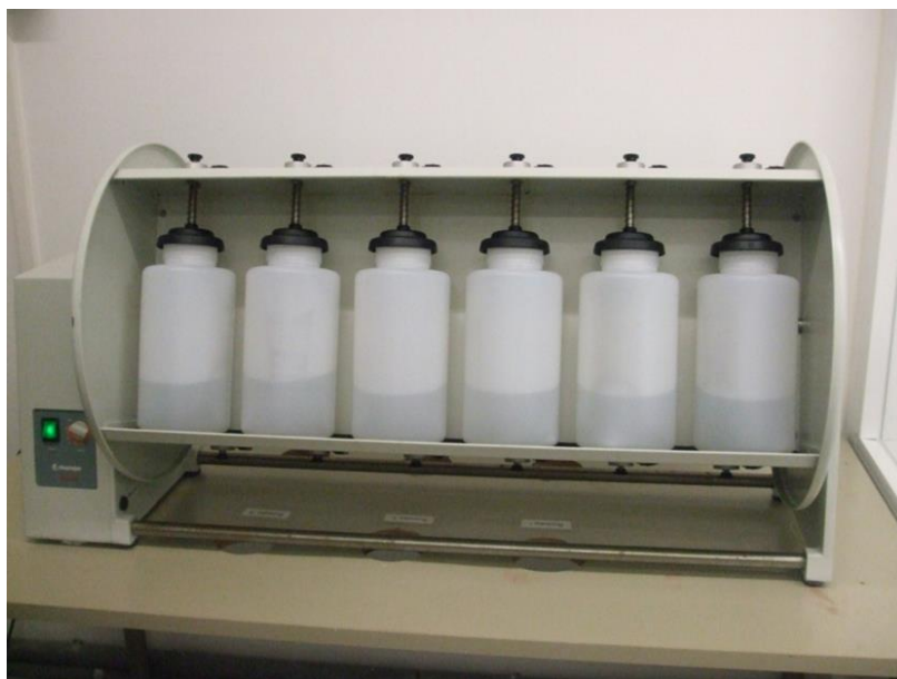
Figura 5: Ensayo de conformidad dónde puede apreciarse los botes en el gira-botellas. Estos contienen el material junto con el agua destilada.
