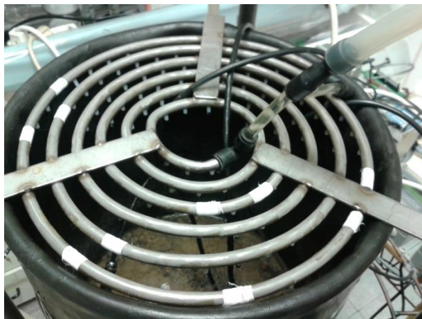
Figura 9: Detalle del sistema de goteo junto con los sensores (higrómetros y termómetros) colocados en la superficie de la MASA en la columna grande.
