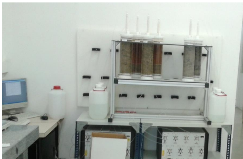
Figura 6: Ensayo de percolación en columnas de 10 cm de diámetro, donde puede apreciarse el sistema de bombeo responsable del flujo ascendente, el detalle de las columnas y la recogida del eluato.
